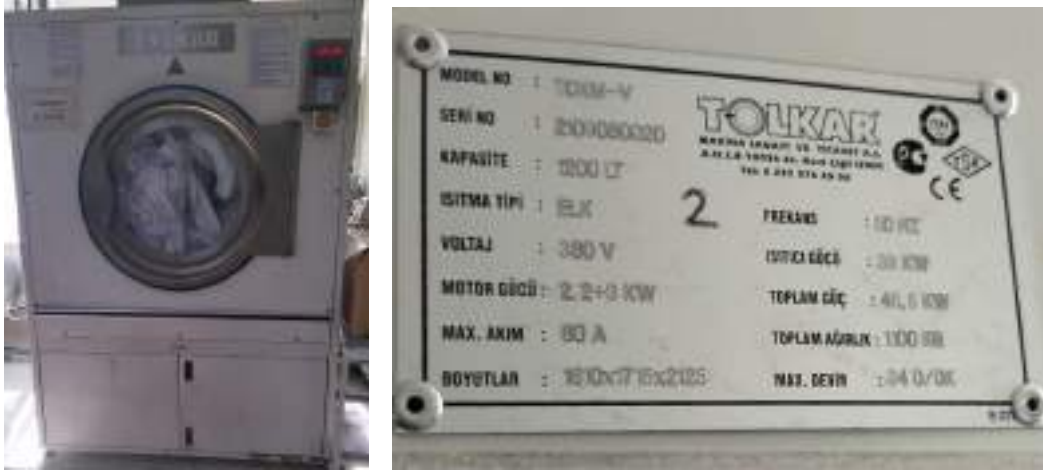
Fotoğraf 3. 114. Endüstriyel Tip Çamaşır Kurutma Makinesi ve Etiket Bilgisi
